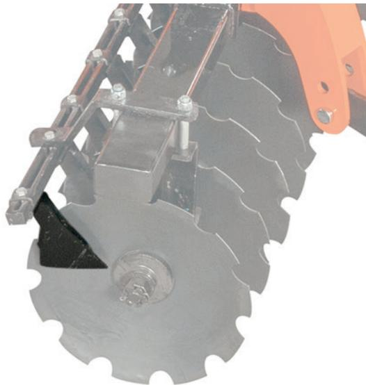
Обладая мощной рамой и дисками диаметром 610 мм, агрегат способен работать на глубине 18-20 см в зависимости от типа почвы. Передний ряд зубчатых дисков отлично заглубляется и поднимает большое количество растительных остатков, предварительно перемешав их с землей. Второй ряд гладких дисков дополнительно нарезает и измельчает пожнивные остатки. Благодаря расстоянию между дисками в 230 мм дисковые бороны CDHV проводят очень качественное дискование.
