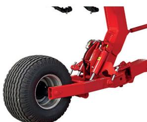
Плуги точно удерживают глубину вспашки при низком давлении на грунт благодаря опорно-транспортному колесу большого диаметра, а также дополнительному переднему опорному колесу, которое, в свою очередь, уменьшает нагрузку и на навеску трактора.
