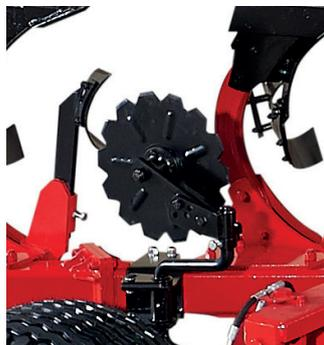
Дисковый нож в серийной комплектации – отвечает за чистую вспашку. Точный проход дискового ножа способствует полному обороту пласта и тщательной заделке растительных остатков.
